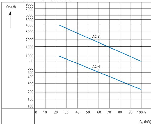
モータブレーカおよび高遮断容量コンパクトスタータの遮断容量
