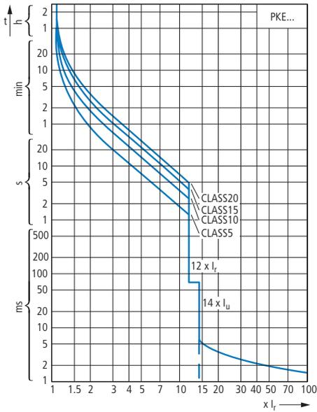
限流特性: モータブレーカ、トランス保護用ブレーカ、コンビネーション用ブレーカ
