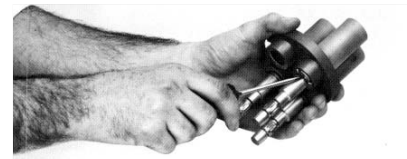
Figure 3. Enlèvement de la pince de retenue
