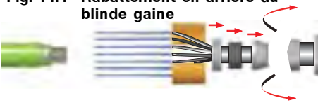
Fig. 14.5 Application de la douille isolante fractionnée „klick“
