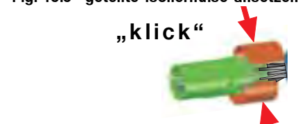
Fig. 15.5 geteilte Isolierhülse ansetzen
