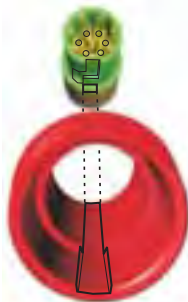
Fig 13.3 Montage du connecteur à ressort de rappel en cage
