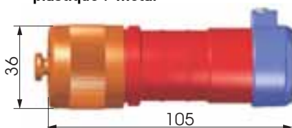
Fig 8.5 Illustration cotée matière plastique / métal
