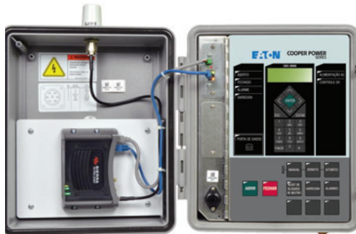
Figura 7. Controle CBC-8000 com modem.
