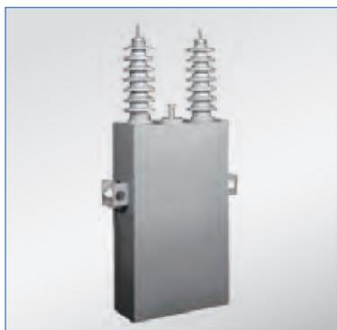
EX™-7Li 型电容器是全膜内熔丝电容器，采用最新的设计理念——延伸铝箔及无焊接连接，CLEANBREAKOR 单元熔断系统，激光切割铝箔技术——具有极高的占空系数。库柏电容器的设计、生产、试验符合甚至超过 NEMA、ANSI/IEEE、IEC 以及 GB、DL 等标准要求，对于电力系统提高功率因数，减少电压降，降低损耗，提高电力传输能力，是一个简易的，经济的，可靠的无功补偿设备。
