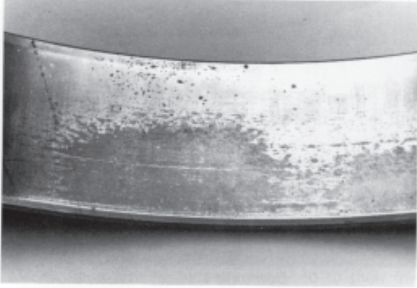
"Descamação" da pista de rolamento
