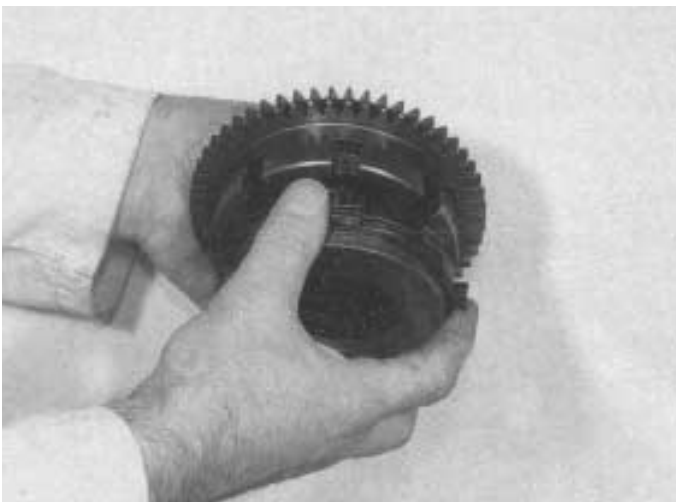
7. Quitar del cubo estriado y del engranaje los discos de freno con forro y los sin forro.
