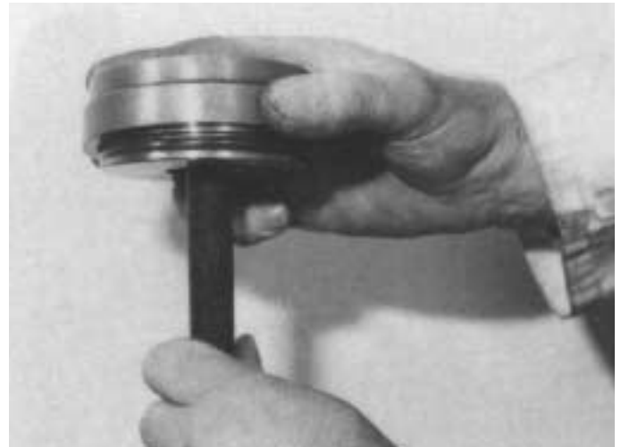
9. Separar el pistón del plato de empuje.
