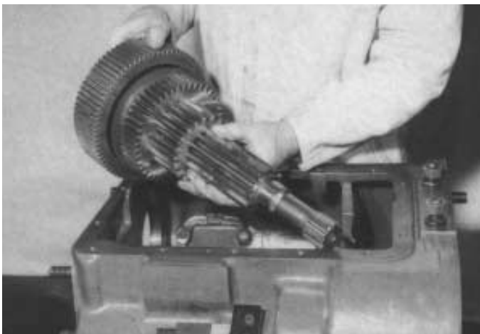
21. Quitar los cojinetes del eje secundario inferior (izquierda) de modo idéntico a como se hizo en las operaciones 13 a 16 inclusive relativas al eje secundario superior, sacando luego de la carcasa el eje secundario.
