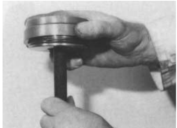
9. Kolben von der Druckplatte abnehmen.
