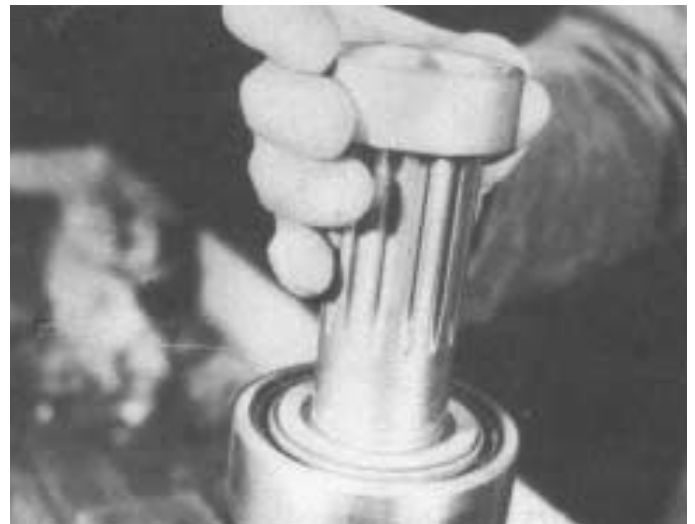
4. Distanzring über die Zapfwelle gegen das Lager schieben.
