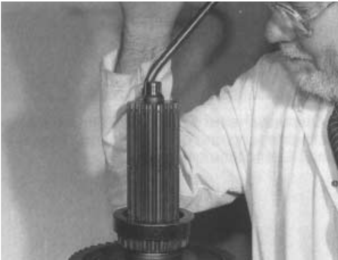
25. Die Schalmuffe auf die Hauptwelle schieben, die Feder mittels Werkzeug E113 zusammendrücken und den Sicherungsring einsetzen.
