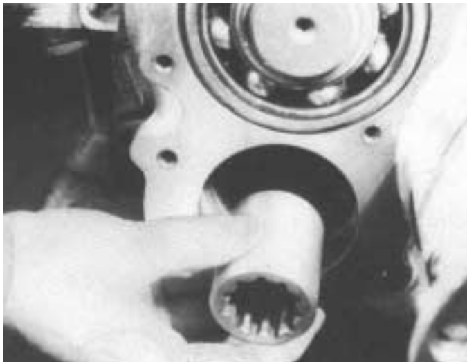
2. Zwischenstück durch das Gehäuse auf den Zapfen der unteren linken Vorgelegewelle setzen.
