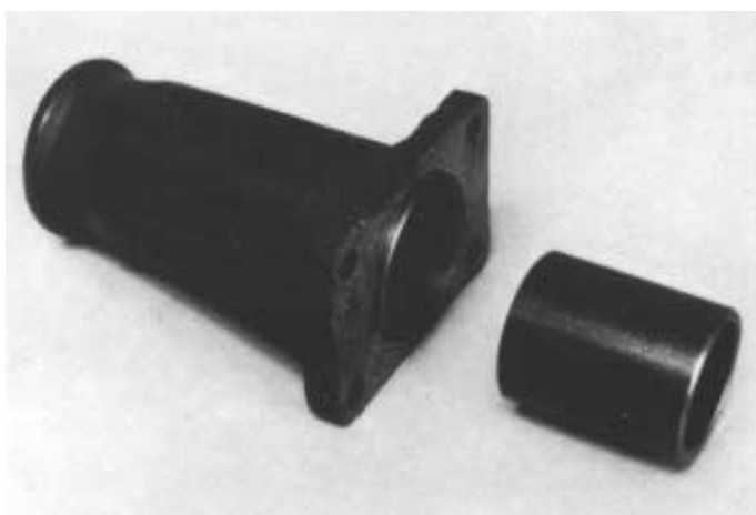
3. Distanzhülse vom vorderen Gehäusedeckel abnehmen.
