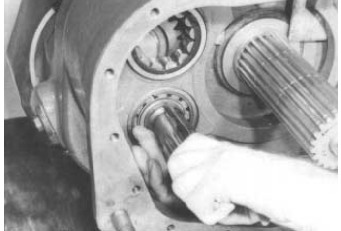
5. Sicherungsringe vom hinteren Ende beider Vorgelegewellen entfernen.
