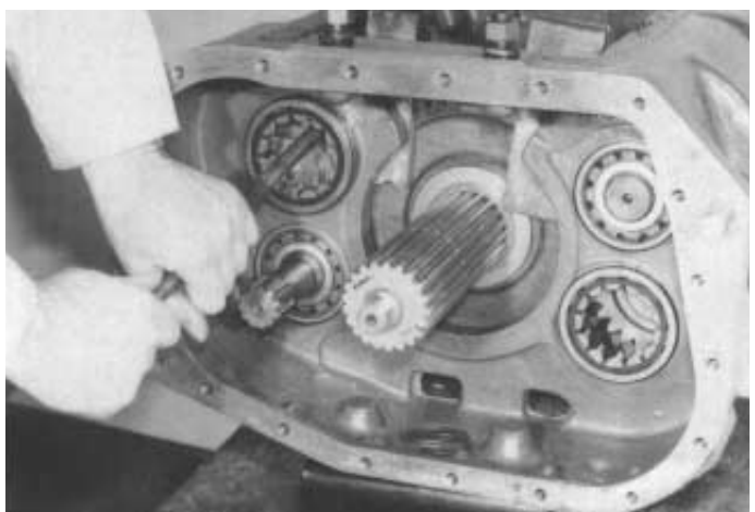
6. Mit einem Montierhebel die beiden vorderen Lager der Vorgelegewellen aus dem Gehäuse hebeln.
