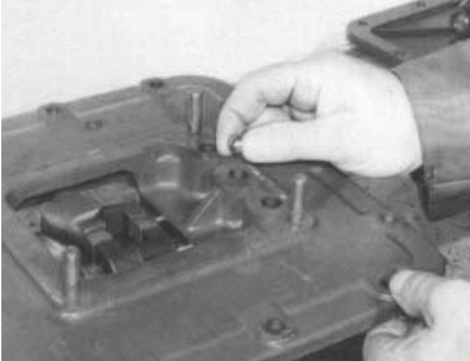
11. Die drei Kugeln für die Gangarretierung in die Bohrungen des Schaltdeckels einlegen.
