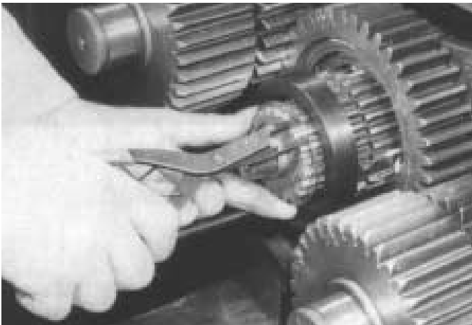
12. Mit Federspanner E 113 Schalmuffe gegen die Feder drücken und mit Zange T-700A vom hinteren Teil der Hauptwelle abnehmen.
