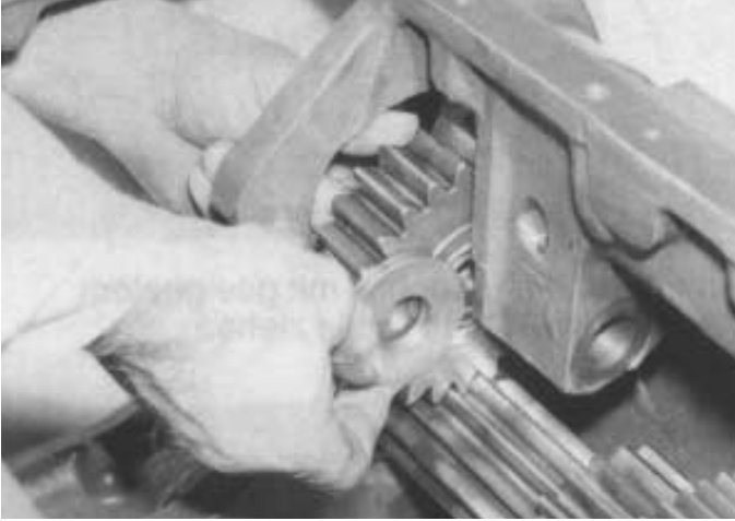
19. Rückwärtsgang-Umkehrad und Scheibe aus dem Gehäuse nehmen.
