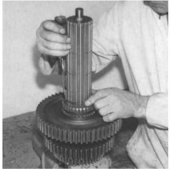
18. Den vorderen Sicherungsring des Zahnrad für den Rückwärtsgang in der Nut auf der Hauptwelle einlegen.
