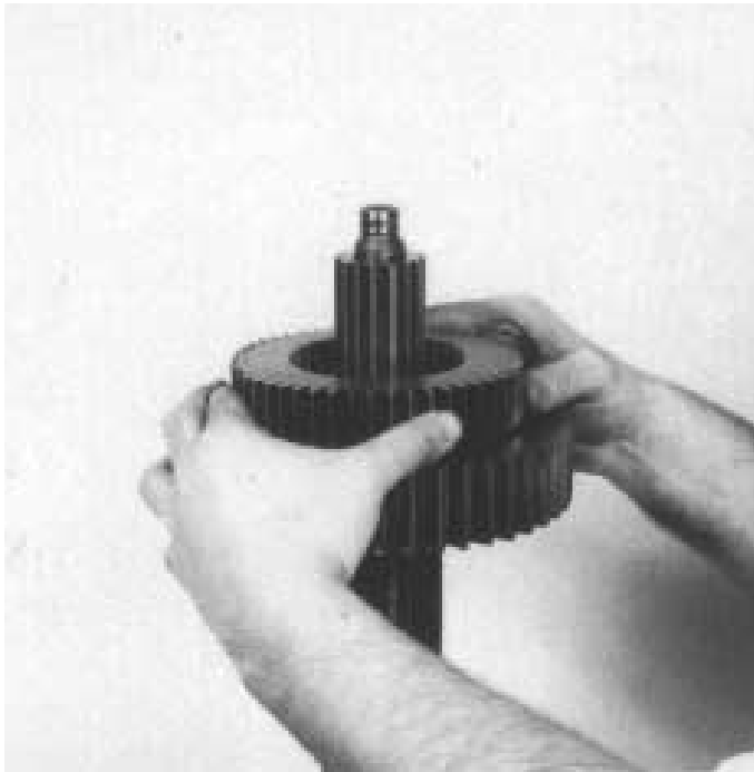
8. Das Spiel des 2.-/3.-Gangrades auf der Hauptwelle muß nun eingestellt werden.
