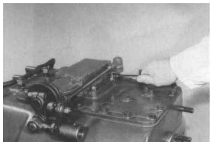
12. Vorderen Gehäusedeckel montieren. Schalthebel und Stabilisator einbauen und Fernschaltung an Schaltgehäuse anbringen.
