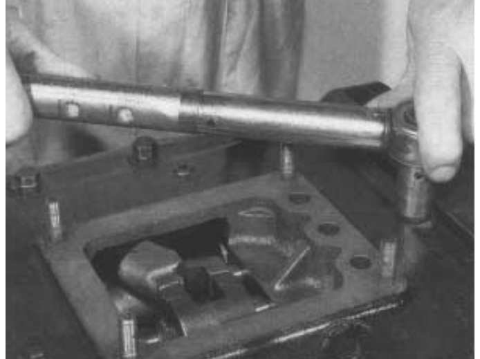
13. Die Skt.-Schrauben einsetzen. Auf die Position der Hebeösen und der dazugehörigen zwei längeren Skt.-Schrauben achten. Bei falscher Montage der Hebeösen und Schrauben kann ein Zahnrad der rechten Vorgelegewelle blockiert werden. Alle Schrauben mit dem vorgeschriebenen Drehmoment anziehen.
