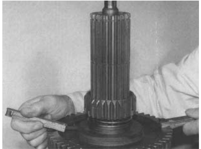
26. Das Spiel zwischen Zahnrad des Rückwärtsgangs und der Distanzscheibe mit zwei Einstellehren messen. Falls das Spiel nicht in der vorgeschriebenen Toleranz liegt, muß die Anlaufscheibe (an der Schiebemuffe liegend) wieder ausgebaut und, je nach Bedarf, durch eine dickere oder dünnere ersetzt werden.
