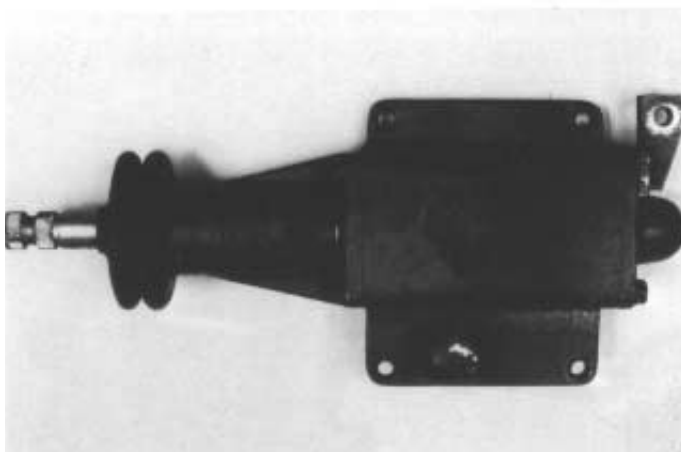
1. Fernschaltung vom Schaldeckel abmontieren, Schalthebel und Stabilisator abbauen.
