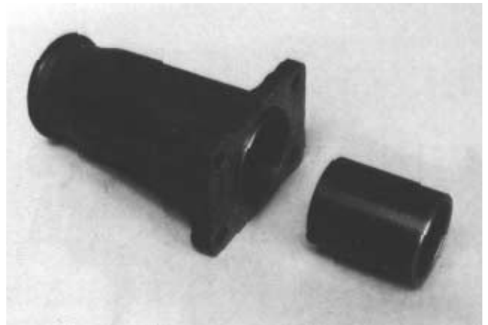
11. Distanzhülse in vorderen Gehäusedeckel einsetzen.
