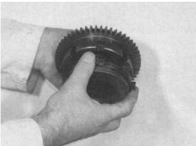
7. Bremsscheibensatz von der Keilverzahnung der Welle und dem Zahnrad abnehmen.
