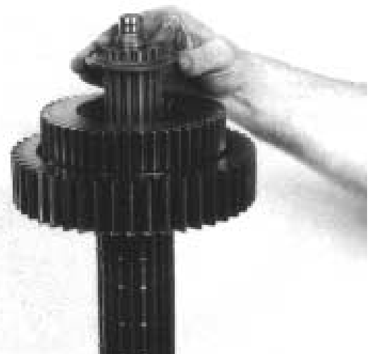
7. Das 3.-Gang-Zahnrad mit der Schaltverzahnung nach oben, ausgewählte Anlaufscheibe und Sicherungsring montieren.
