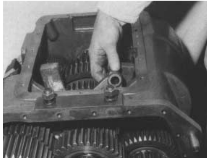
13. Die Schaltgabel in die Nut der mittleren Schieberäder einsetzen. Der abgesetzte Hals zeigt nach vorn.
