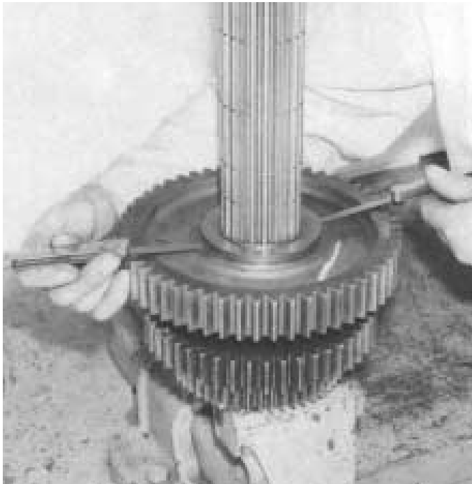
16. Das Spiel zwischen dem Zahnrad, 1. Gang und der Distanzscheibe mit zwei Einstelllehren prüfen. Falls das Spiel nicht in der vorgeschriebenen Toleranz liegt, muß die Anlaufscheibe (an der Schiebemuffe liegend) wieder ausgebaut und durch eine dickere oder dünnere, je nach Bedarf, ersetzt werden.
