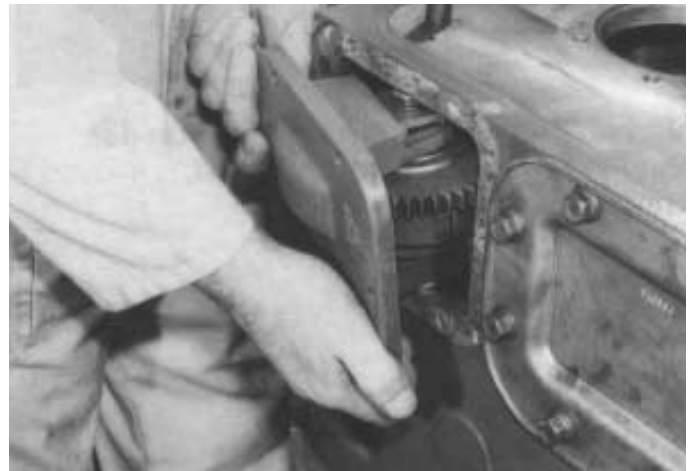
23. Getriebeklemme vom Boden des Gehäuses abschrauben.
