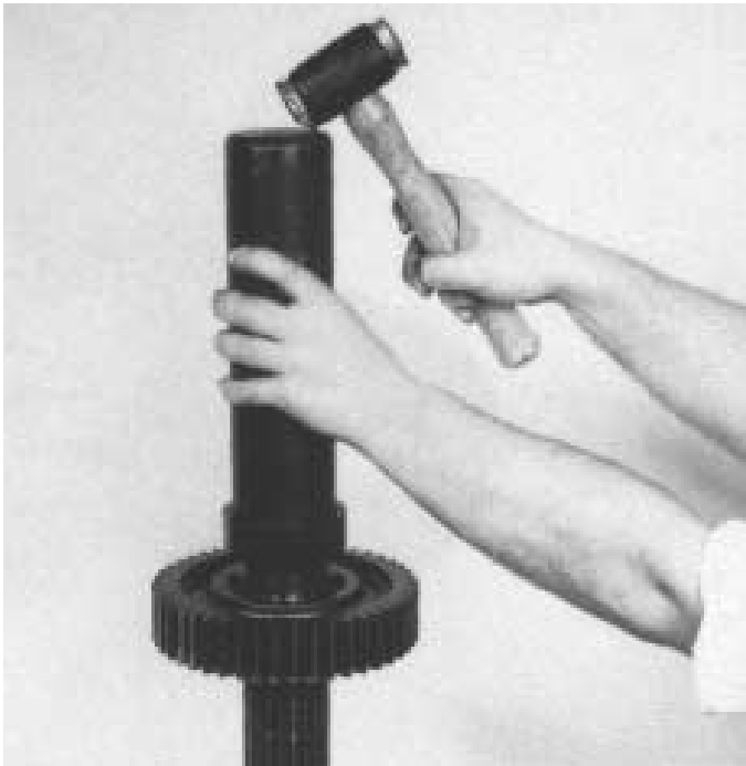
4. Scheibe des 2.-/3.-Gang-Zahnrades auf die Welle pressen.
