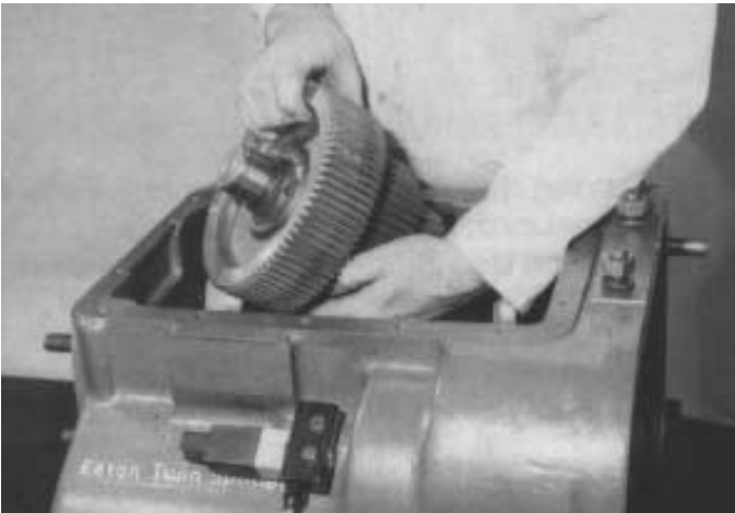
20. Obere (rechte) Vorgelegewelle aus dem Gehäuse heben.
