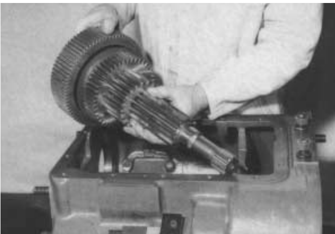
21. Lager von der unteren (linken) Vorgelegewelle in der gleichen Weise entfernen wie unter 13 bis 16 beschrieben. Anschließend Vorgelegewelle aus dem Gehäuse heben.
