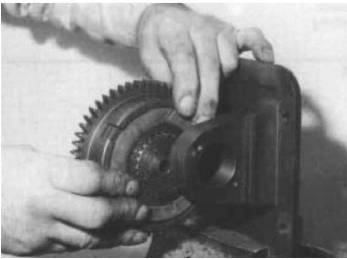
6. Zahnrad mit Welle und Bremsscheibensatz herausnehmen.
