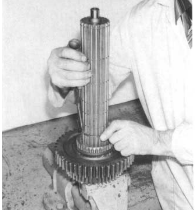
10. Sicherungsring für das Zahnrad, 1. Gang, in der Nut auf der Hauptwelle einsetzen.
