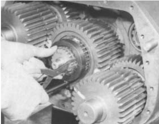
11. Die lange Feder über die Hauptwelle schieben. Schaltmuffe (mit markierten Sperrzähnen nach oben) über die Hauptwelle schieben und gegen die Feder drücken, bis die Sicherungsnut in der Hauptwelle freiliegt. Sicherungsring mit Zange T-700 A in die Nut der Hauptwelle einsetzen. Werkzeug: E 113.
