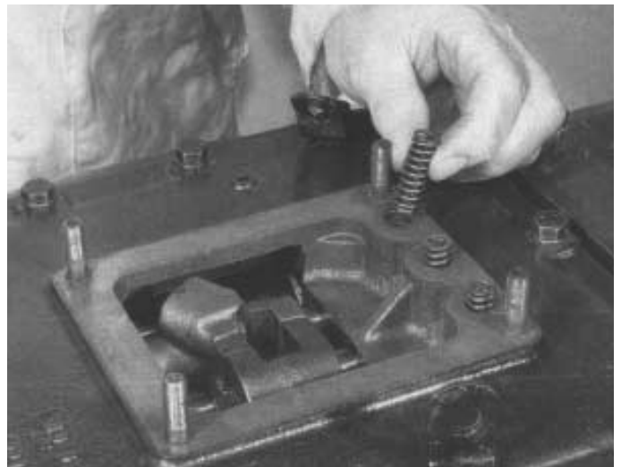
14. Sicherstellen, daß alle Schaltstangen sich in Neutralposition befinden. Die drei Druckfedern in die Bohrungen einlegen.
