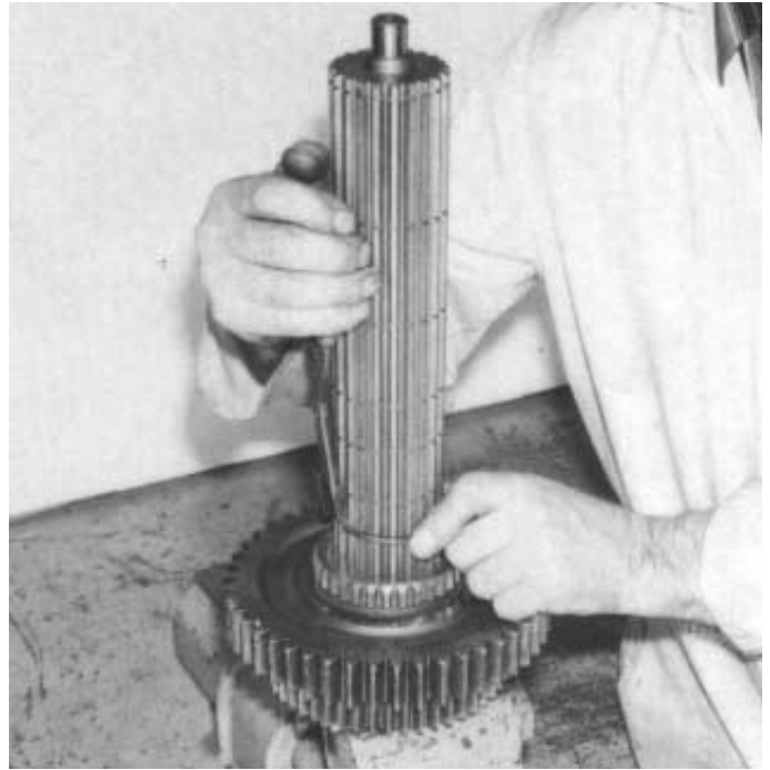
10. Sicherungsring für das Zahnrad, 1. Gang, in der Nut auf der Hauptwelle einsetzen.
