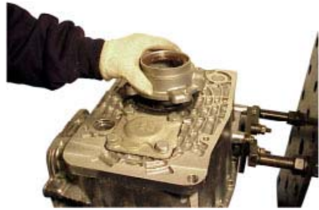
26. Переверните заднюю крышку на стенде и удалите винты, крепящие корпус спидометра. Запишите позиции винтов различной длины. Снимите корпус. При необходимости выньте масляное уплотнение.
