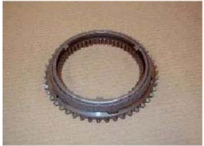
g) Установите кольцо трения синхронизатора на фланец синхронизатора, убедившись, что выступы на кольце трения синхронизатора входят в пазы на фланце синхронизатора.
