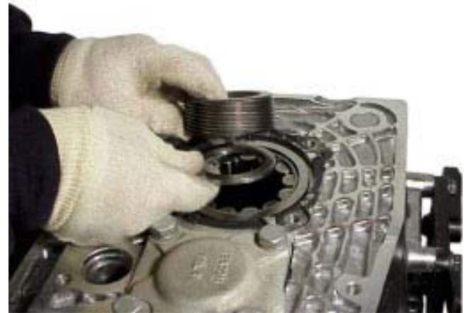
27. Снимите ведущую шестерню привода спидометра или ротор тахографа и втулку подшипника с тыльной половины корпуса.
