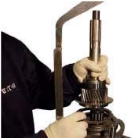
24. Поднимите входной вал с фланцем шестой передачи. Снимите кольцо синхронизатора шестой передачи.
