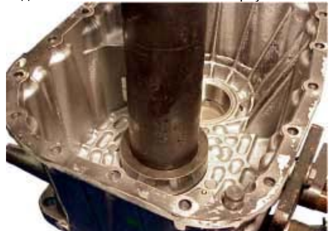
28. Переверните корпус на стенде и с помощью специального инструмента снимите задний подшипник главного вала. Не допускайте, чтобы подшипник упал на пол.
