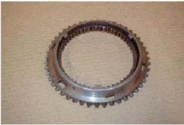
е) Установите внутреннее кольцо синхронизатора, зубцами вверх, на фланце синхронизатора.
