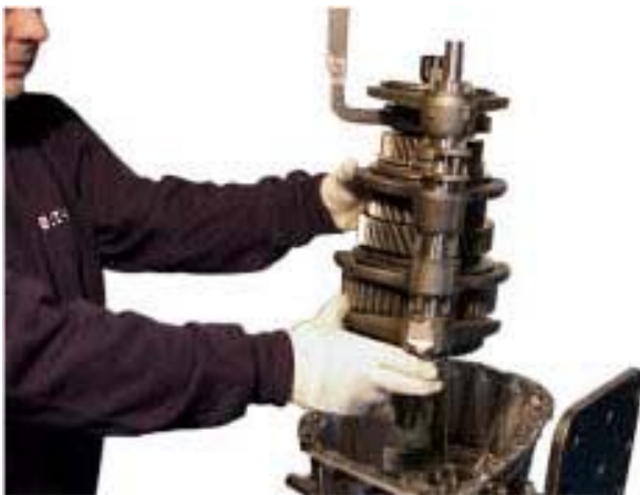
25. Поднимите подъемное устройство и снимите главный вал, вал искателя и вилки, как один узел. Осторожно опустите на чистое рабочее пространство и снимите специальный инструмент. Отделите вал искателя и вилки от главного вала.
