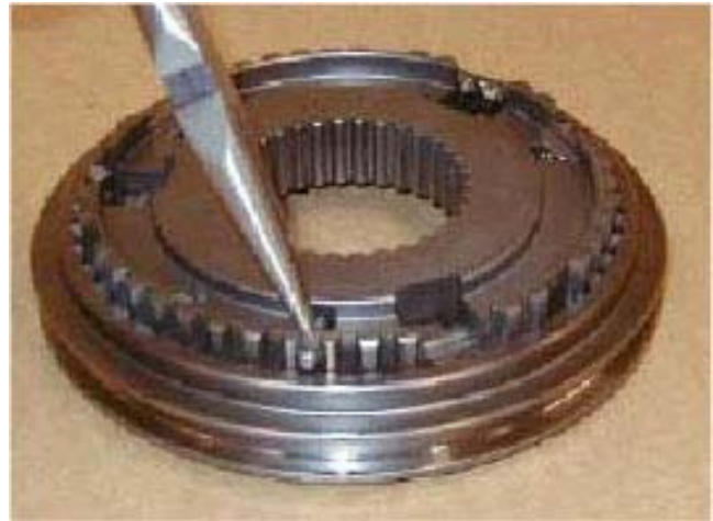
8. Стараясь не потерять шарики или пружины поднимите фиксирующие тарелки чтобы высвободить шарики. После того, как шарики были удалены, можно удалить фиксирующие тарелки и пружины.
