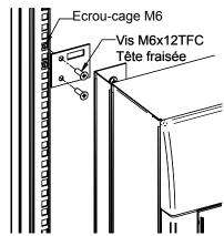
2- Mettre en place les pattes de fixation en respectant les espacements suivant le schéma ci dessous:
