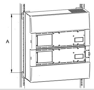
3- Fixer le boîtier sur les pattes de fixation en utilisant les vis M6x16 TCBL, écrous à cage M6 suivant les plans ci-dessous :
