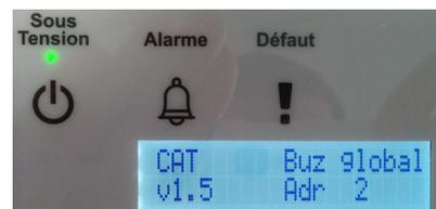
Cet écran permet de visualiser les paramètres de configuration du report. Ces paramètres dépendent de la position des switches de configuration.
