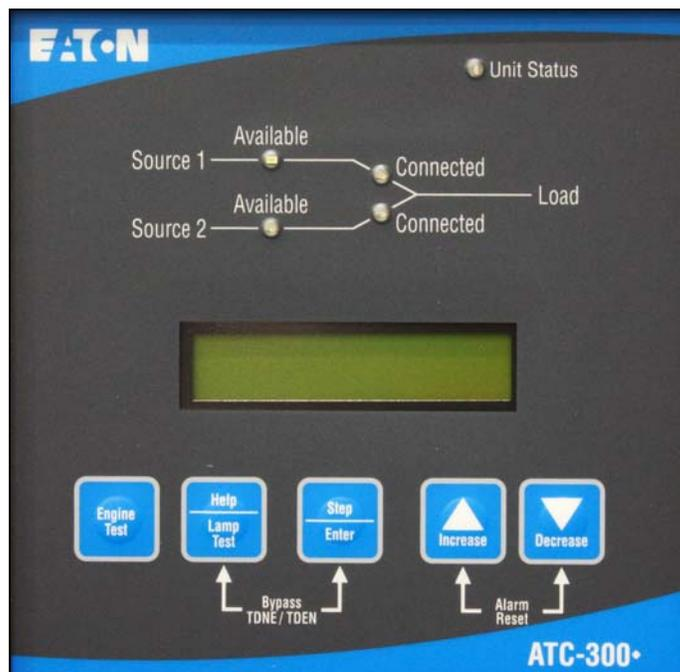
Figure 1. Panneau avant du régulateur ATC-300+ .
