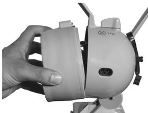
Das LED Gehäuse zuerst unten aufsetzen.
