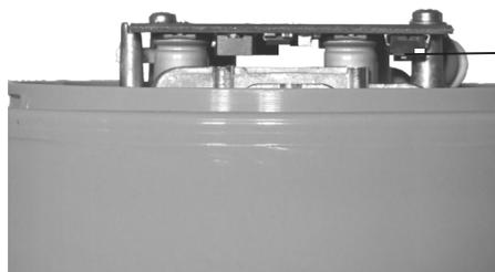
Auswahl zwischen Eco- und Boost Betrieb des Hauptlichts per Schiebeschalter.
