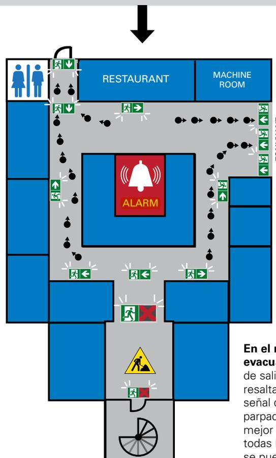
En el modo de evacuación, las vías de salida se pueden resaltar con una señal dinámica (señal parpadeante) para una mejor visibilidad y que todas las vías de salida se puedan encontrar más fácilmente.
