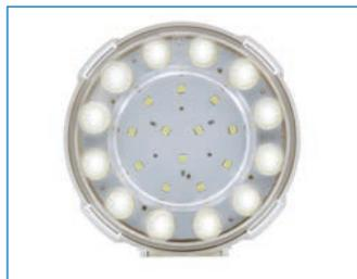
La distribuzione stretta della luce rende possibile l'installazione in vie di esodo larghe e l'illuminazione di apparecchi per la sicurezza. Una distanza massima di 16,5 m tra gli apparecchi di illuminazione riduce il numero di punti luce necessari e un campo di applicazione da 5 m fino a 20m per 1Lux consente il montaggio alle altezze comuni.
