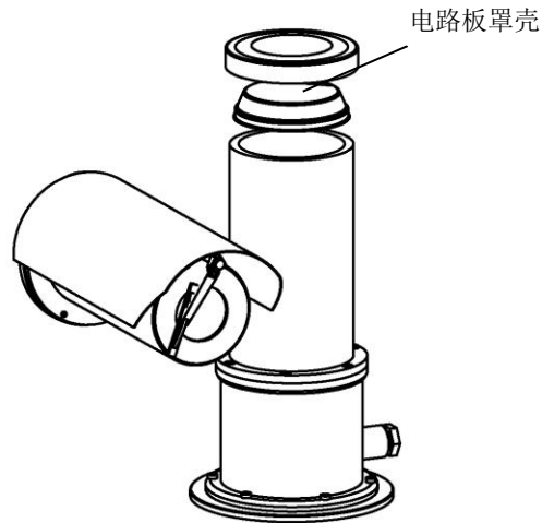
图 13. 电路板罩壳固定
