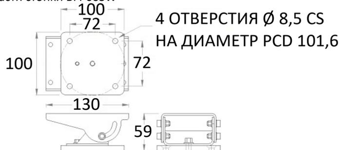
Рис. 8 Кронштейн для настенного крепления BFW32SW с поворотным соединением
