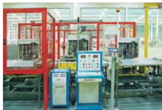
断路器耐压测试工位
