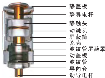
真空灭弧室内部结构
