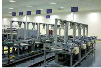
CEG 断路器磨合测试工位
