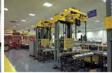
CEG 断路器机械特性测试工位
