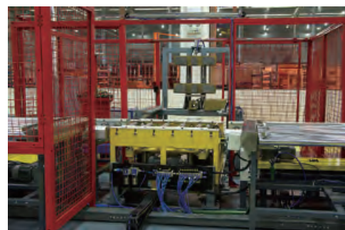
CEG 断路器耐压测试工位
