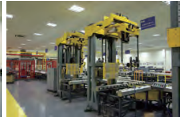
CEG 断路器机械特性测试工位
