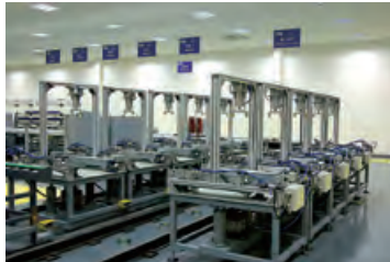
CEG 断路器磨合测试工位
