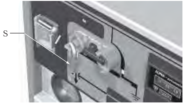
图31:剪形联锁上的挂锁
