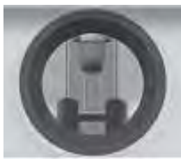
图16-3:隔离开关处于隔离位置
