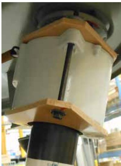
**Figura 18. Transformador de corrente interno montado na bucha.**
