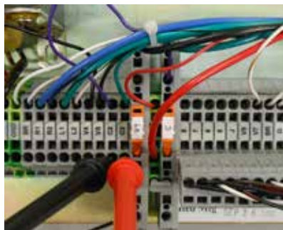
Figura 25. Puntos de conexión del miliamperímetro.
