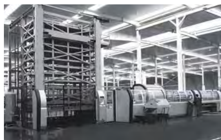
自动钣金柔性加工生产线
