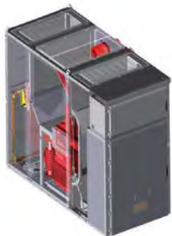
开关柜整体结构图
