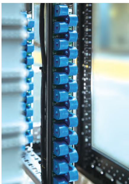
CT 条采用 0.2 级的电流互感器，保证了测量的精度。可按负载数量选择 8 路、12 路、21 路 CT 条，给客户提供更经济的选择。
