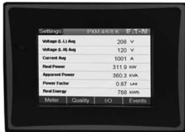
Power Xpert Meter Display
