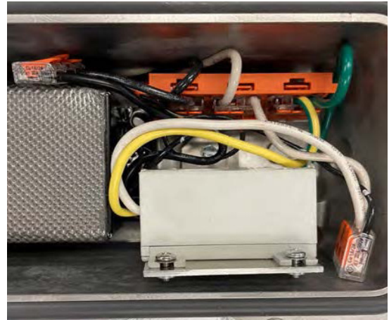
Figure 2. Branchement des fils d'entrée du module de surtension
