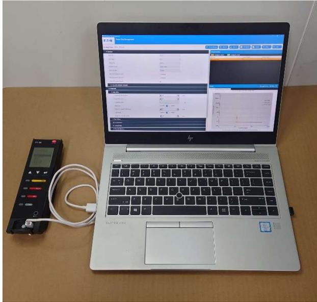
图 2.2: USB 至 Micro-USB 电缆和 PT 脱扣单元
