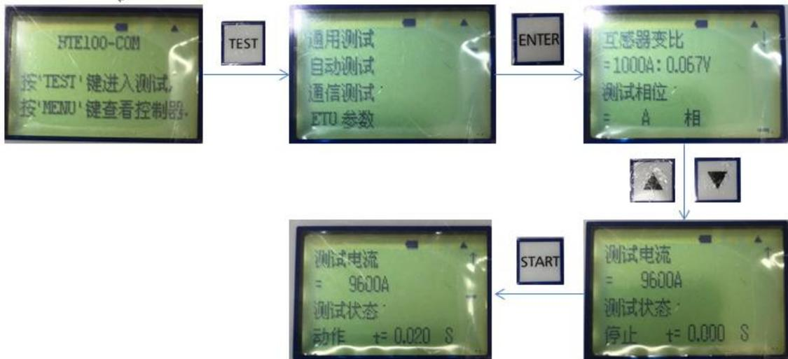
同样设置下对接地保护进行测试，如下图所示：
