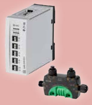
Ein-/Ausgabemodule in digitaler und analoger Ausführung zur Einbindung von herkömmlichen Aktoren oder Sensoren im Schaltschrank in Schutzart IP20 und für direkte Installation am Sensor/Aktor an der Maschine in Schutzart IP67.
