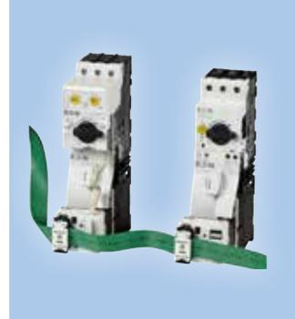
Der PKE ist ein Motor- und Anlagenschutzschalter mit modularen Auslöseblöcken, dessen Überlastschutz elektronisch realisiert wird. Der Zwei-Komponenten-Motorstarter, bestehend aus Leistungsschütz DILM und Motorschutzschalter PKE, eignet sich für den einfachen Komponentenaustausch durch steckbare Verbindungstechnik bis 15 A Nennstrom.
