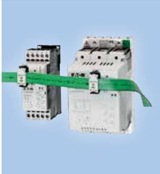
Der Softstarter DS7 ist ideal für die Anwendungen an Pumpen, Lüftern und kleineren Förderbändern. Er ist ein voll integrierter Baustein im xStart-System. Der DS7 ersetzt das mechanische Schütz und erweitert dieses um die Funktion „Motoren sanft starten“. Längere Serviceintervalle und geringere Betriebskosten.
