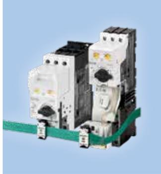
Der Zwei-Komponenten-Motorstarter, bestehend aus Leistungsschütz DILM und Motorschutzschalter PKZ, eignet sich für den einfachen Komponentenaustausch durch steckbare Verbindungstechnik bis 15 A Nennstrom. Zusätzlich lassen sich die Motorstarter bis 32 A mit Montageverbinder schnell und fehlerfrei aufbauen.
