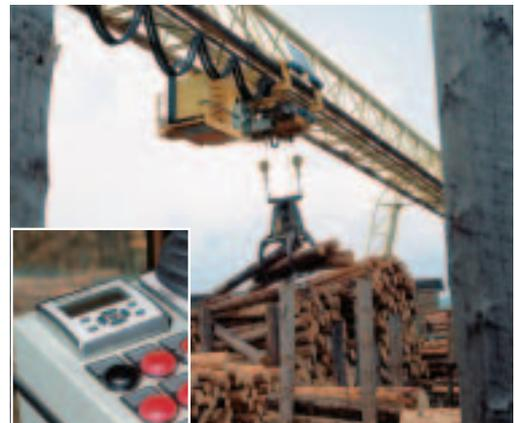
MFD-Titan übernimmt im Steuerstand der Krananlage die Funktion der Bedienerschnittstelle, z.B. zur Visualisierung von Störmeldungen und Betriebszuständen.
