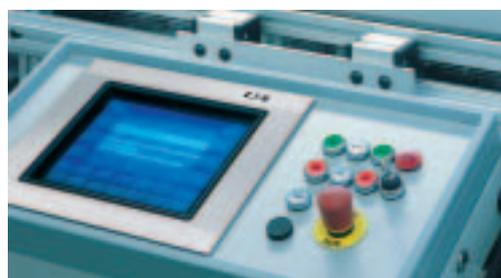
Das Touch Panel visualisiert die Anwendung und bildet die Bedienerchnittstelle.
