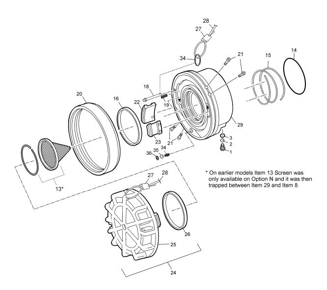
FIGURE 1 – BASIC UNIT BREAKDOWN
