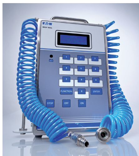
Abb. 2 Ein Integritätstestgerät ermöglicht die vollautomatische Messung von Membranfilterkerzen. Sowohl Filterkerzen in kleinen als auch großen Gehäusen können getestet werden
