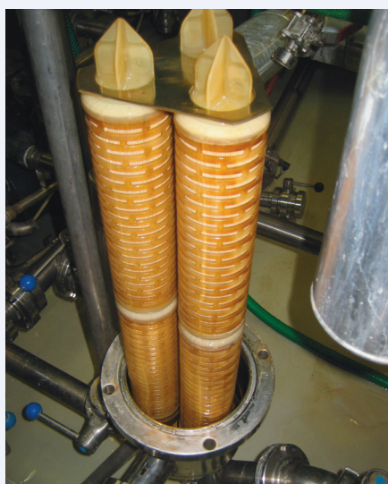
Fig. 3 - Spessi depositi di sporco e ferro (cartucce filtranti)
