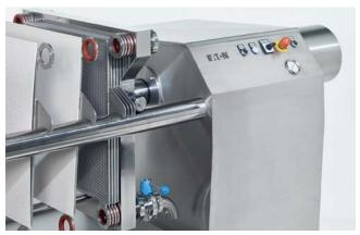
Der BECO COMPACT PLATE A600-Schichtenfilter ist ein hochwertiger Mehrschichtenfilter mit umfangreichen Ausstattungsoptionen. Die Filterfläche kann flexibel an die jeweilige Anwendung angepasst und der Produktaustritt durch das optimierte, beidseitig offene Tubulusgitter und die hydraulische Anpressvorrichtung mit automatischer Nachpressung auf ein Minimum reduziert werden.
