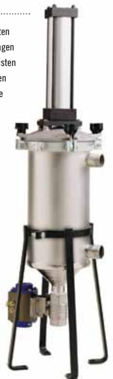
Der DCF-800-Filter ist selbstreinigend, da angelagerter Schmutz auf dem Filtersieb mit Hilfe einer Reinigungsscheibe entfernt wird, die sich parallel zum Flüssigkeitsstrom auf dem Sieb von oben nach unten bewegt. In der Aufangkammer am Boden des Filters wird an-
