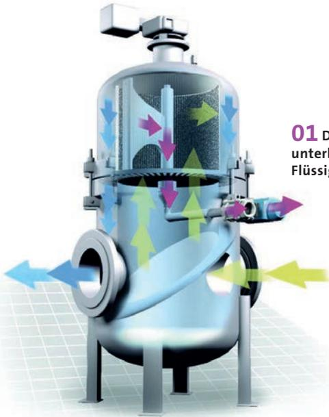
**01** Dieser Siebkorbfilter ist für die kontinuierliche, unterbrechungsfreie Entfernung von Feststoffen aus Flüssigkeiten in Rohrleitungssystemen ausgelegt
