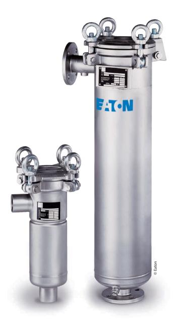
Das einplätzige Beutelfiltergehäuse ist ein Feingussfilter und eignet sich für die meisten schwierigen Industrieanwendungen. Der seitliche Einlass mit Verdrängerdeckel verhindert den Austritt des Unfiltrats und macht einen einfachen und sauberen Filterbeutelwechsel möglich.
