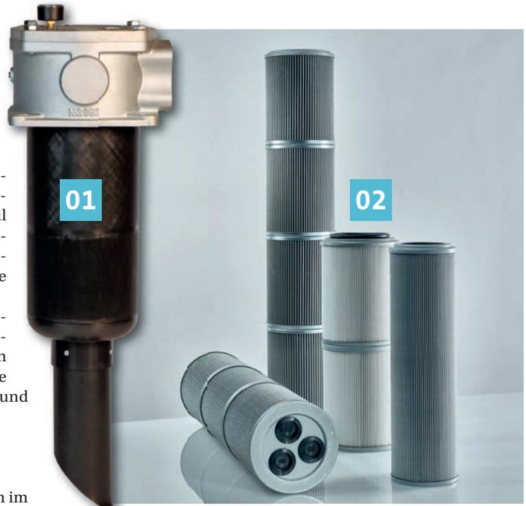
**01** Beim Austausch des Filterelements der Rücklauffilter verhindert eine abnehmbare Verbindung zwischen Filteroberteil und Filtertopf ein Zurückfließen von verunreinigtem Öl in den Tank
