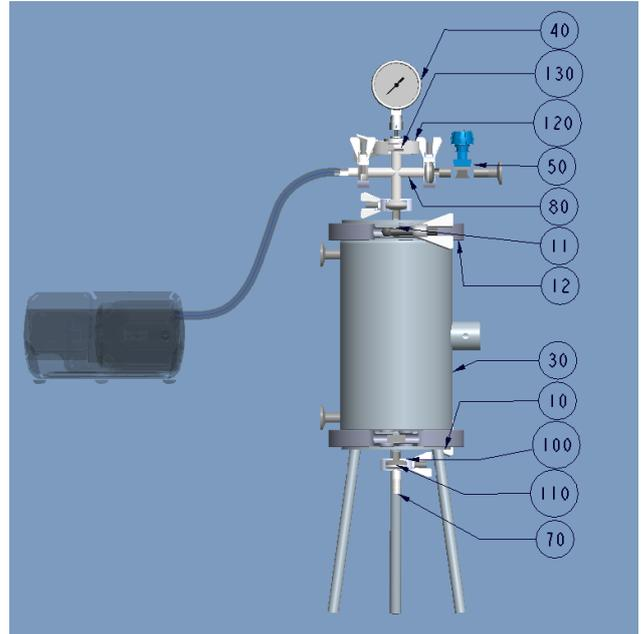
Alternativ Dichtungen in Silikon, Viton und Silikon/FEP-ummantelt erhältlich.
