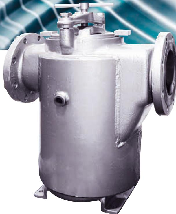
Das Modell 72SJ von Eaton wurde eigens für Anwendungen entwickelt, in denen die gereinigten Medien heiß bleiben müssen, um ihren flüssigen Zustand beizubehalten. Dazu gehören beispielsweise Schokolade, Asphalt, Harze und Polymere. Die Temperatur im Gehäuse des Siebkorbfilters wird dazu auf einem konstanten Niveau gehalten, indem entweder Dampf oder eine Wärmeträgerflüssigkeit in der Ummantelung des Siebkorbfilters zirkuliert.
