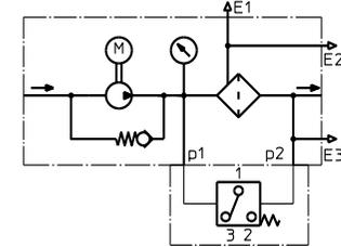
Umlauffiltereinheit mit optischen Verschmutzungsanzeiger AOR, AOC, OP
