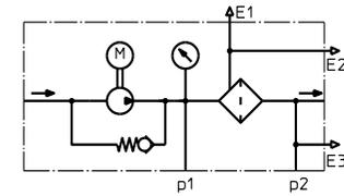
Umlauffiltereinheit mit elektrischen Verschmutzungsanzeiger AE30
