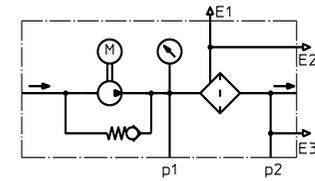
Umlauffiltereinheit mit elektrischen Verschmutzungsanzeiger AE30
