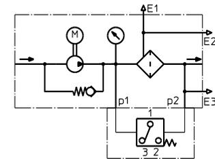
Umlauffiltereinheit mit optischen Verschmutzungsanzeiger AOR, AOC, OP
