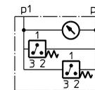
Umlauffiltereinheit mit elektrischem Verschmutzungsanzeiger Schließer E1
