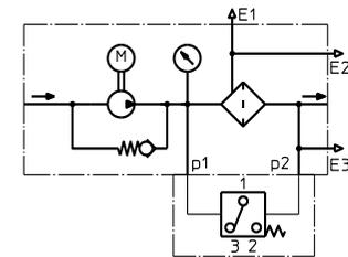
Umlauffiltereinheit mit optischen Verschmutzungsanzeiger AOR, AOC, OP
