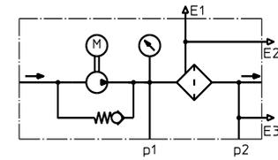
Umlauffiltereinheit mit elektrischen Verschmutzungsanzeiger AE30
