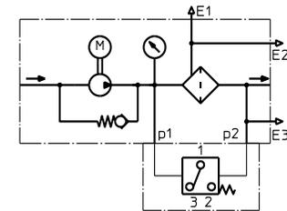
Umlauffiltereinheit mit optischen Verschmutzungsanzeiger AOR, AOC, OP
