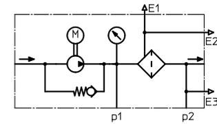
Umlauffiltereinheit mit elektrischen Verschmutzungsanzeiger AE30
