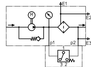
Umlauffiltereinheit mit optischen Verschmutzungsanzeiger AOR, AOC, OP
