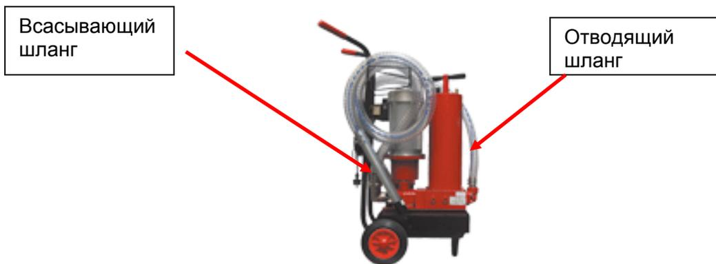
Открытый конец всасывающего шланга во время работы остается погруженным в рабочую жидкость мин. на 100мм. Следует убедиться в том, что циркулирующая жидкость на открытых концах шланговых трубопроводов может беспрепятственно входить и выходить. Если места присоединения шланговых трубопроводов соединены арматурой, следует использовать фитинги, входящие в объем поставки.
