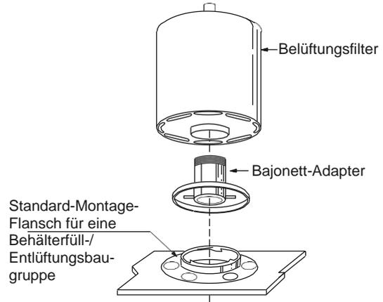
Alle Eaton Belüftungsfilter lassen sich unkompliziert über Spin-On-Adapter an Tanks anbringen.
