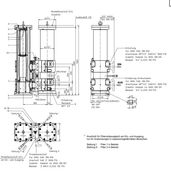
EDELSTAHL-DRUCKFILTER, umschaltbar Baureihe EDA 2214 NPS 3" CLASS 150 PSI Blatt-Nr. 2167 C
